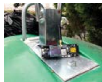
Sonda utilizada para efetuar a medição do nível de sinal nas diferentes situações.
